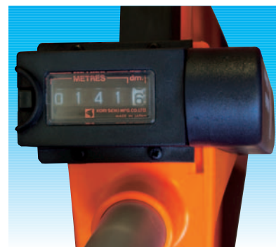
Precisietelwerk met 0,1 m aflezing
